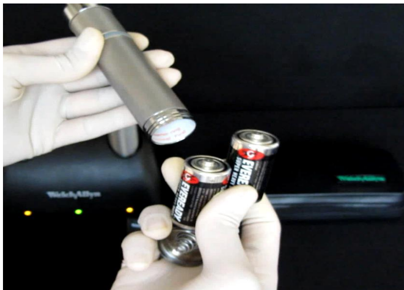
شکل ۵۲- جایگاه دو باتری ۱.۵ ولتی در هندل
