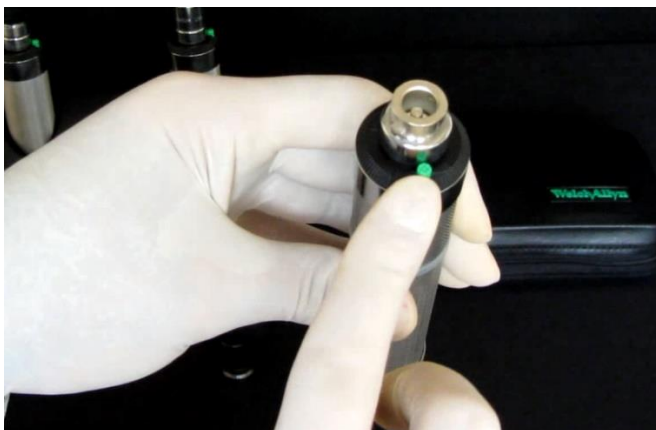
شکل ۵۱- جایگاه کلید ولوم روی هندل
