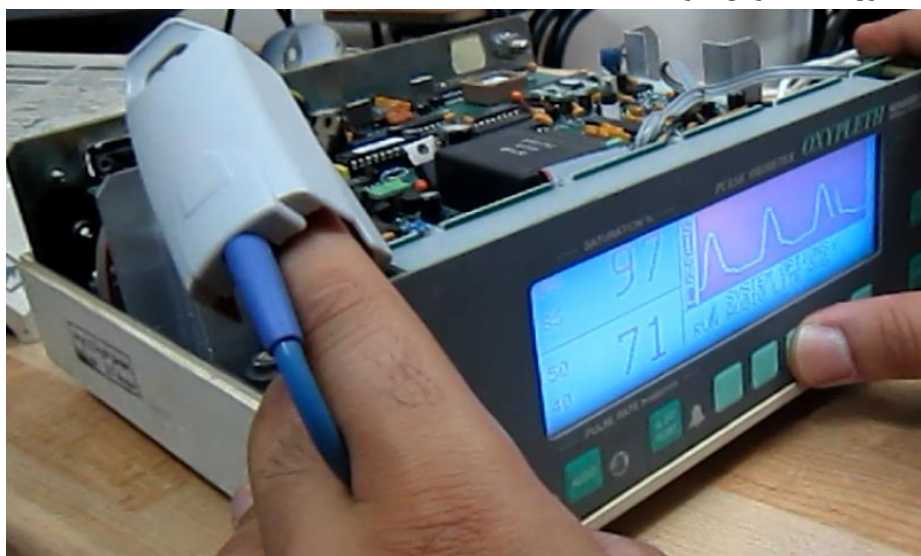
شکل ۷۷- نمایش پارامترهای SpO2 و HR توسط پالس اکسی متر
