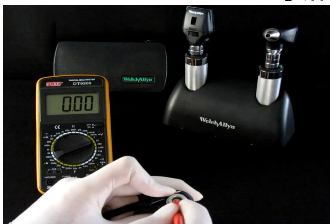
شکل ۶۴- تست عملکرد صحیح هندل در صورت غیرفعال بودن
