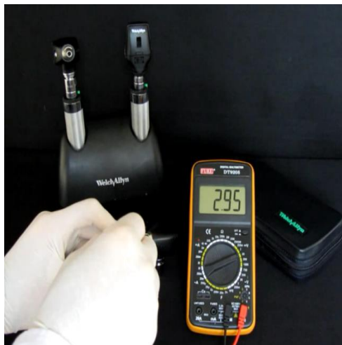
شکل ۴۹- چک کردن سیستم هندل اتوسکوپ
