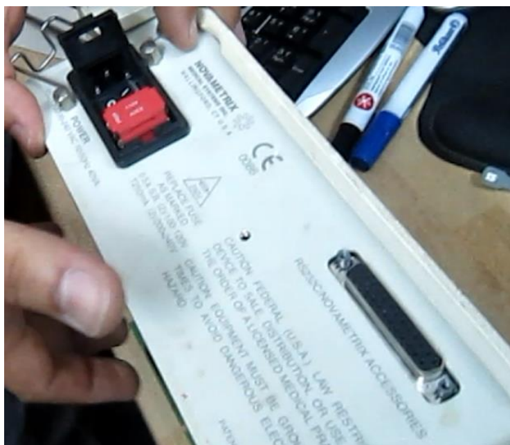
شکل ۷۹- جایگاه فیوز در پالس اکسی متر
