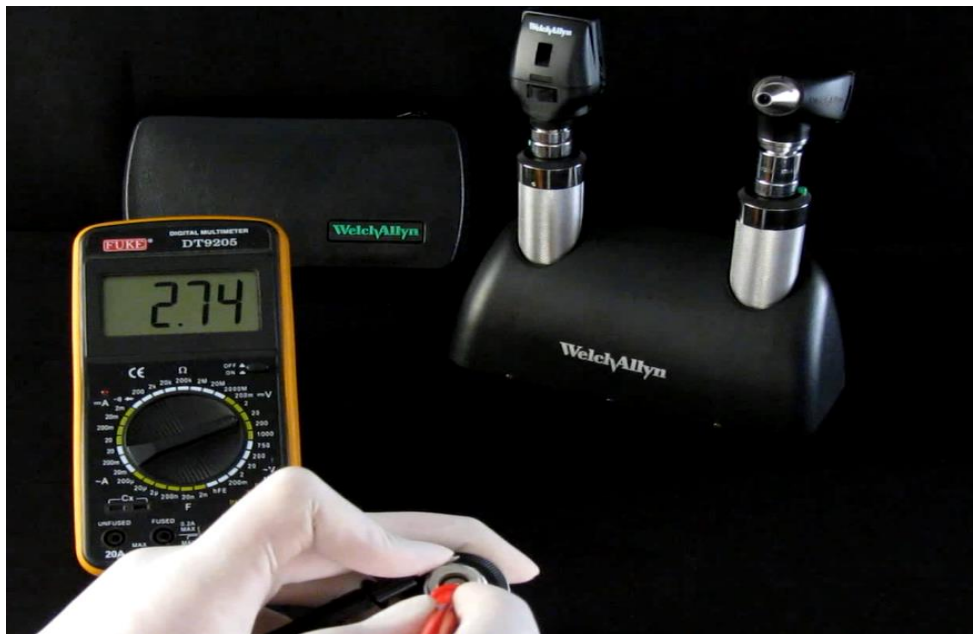
شکل ۶۳- تست عملکرد صحیح هندل در صورت فعال بودن
