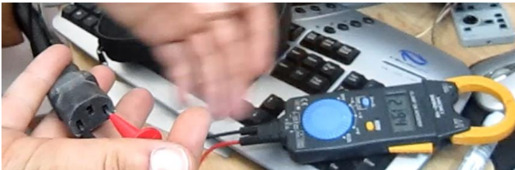
شکل ۲۲- چک کردن کابل پاور با مولتی متر
