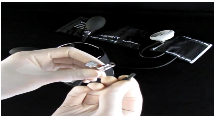
شکل ۷۲-رفع عیب به وسیله خارج کردن پرز از لاستیک روی شیر
