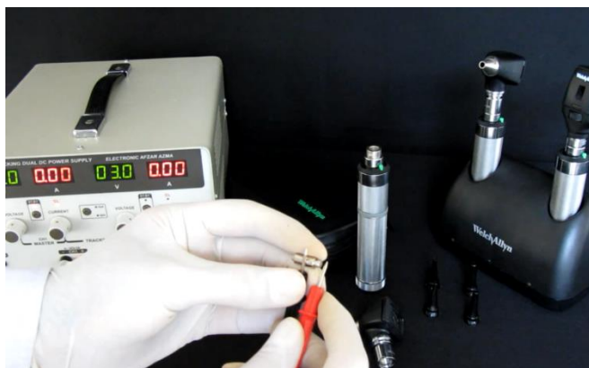
شکل ۴۷- تست لامپ اتوسکوپ
