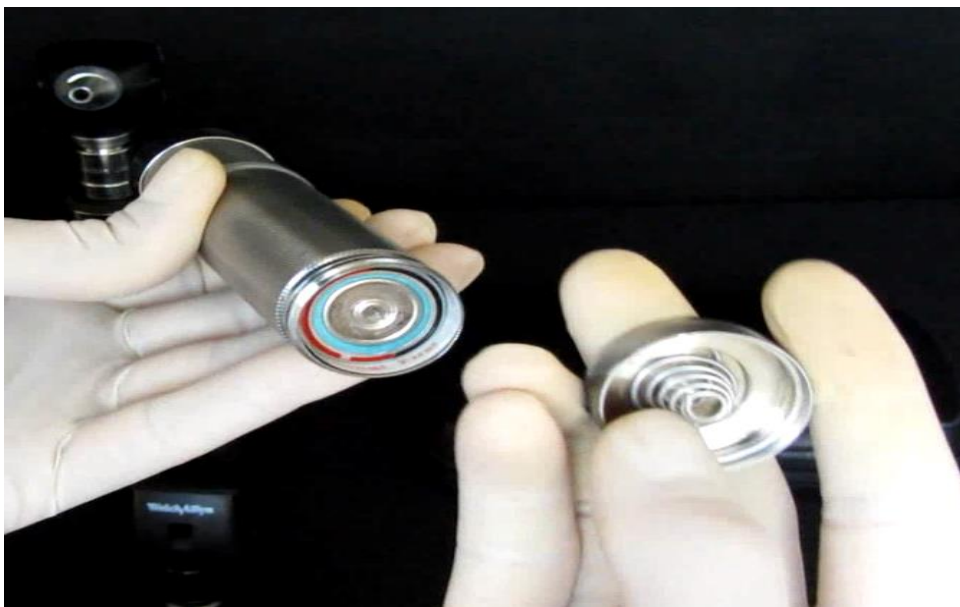
شکل ۵۳- فنر روی درپوش انتهایی هندل
