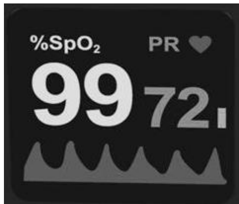
شکل ۱۲۲- پارامترهای نمایشی در دستگاه پالس اکسی متر
