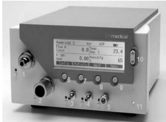
شکل ۱۵۴- دستگاه فلو آنالایزر مورد استفاده توسط شرکت هلت آرمان
