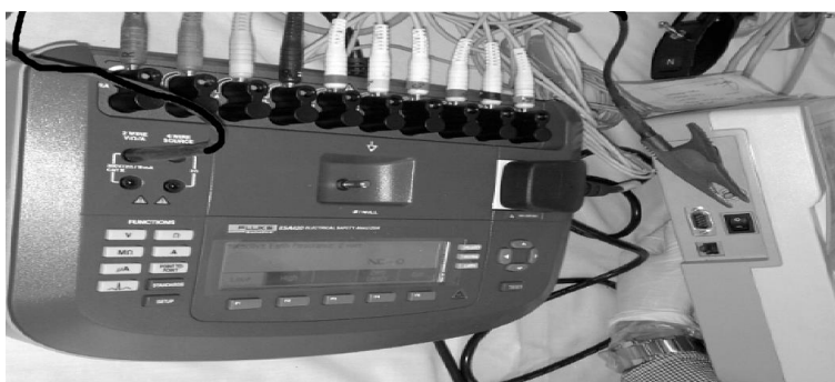
شکل ۱۵۹- آزمون ایمنی الکتریکی دستگاه الکتروکاردیوگراف
