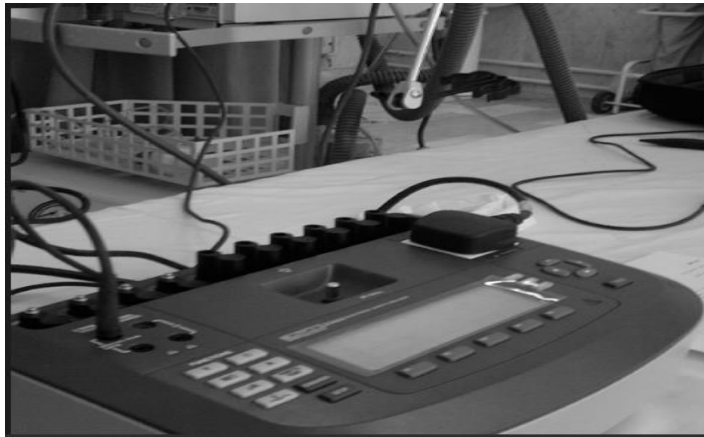
شکل ۱۵۵- دستگاه آنالایزر ایمنی الکتریکی مورد استفاده توسط شرکت هلت آرمان
