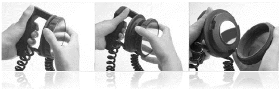
شکل ۴۵- الکترودهای خارجی قابل استفاده برای بزرگسالان و نوزادان
