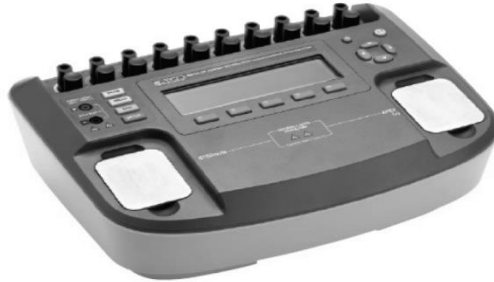
شکل ۱۶۰- دستگاه آنالایزر شوک، مورد استفاده در شرکت هلت آرمان
