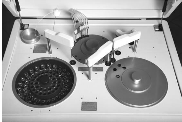
شکل ۱۹۱- نمای داخلی از دستگاه اتوآنالایزر
