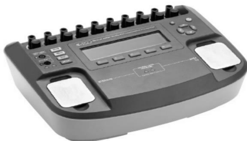
شکل ۱۵۸- دستگاه آنالایزر الکتروکاردیوگراف مورد استفاده توسط شرکت هلت آرمان
