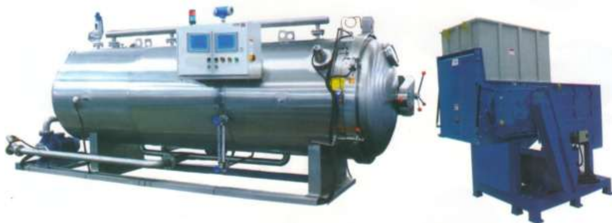
شکل (۱۳-۴). POST SHEREDDER ۵۰۰ با استریلایزر افقی
