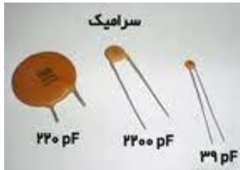
شکل ۶-خازن سرامیکی با ظرفیت پیکوفاراد
