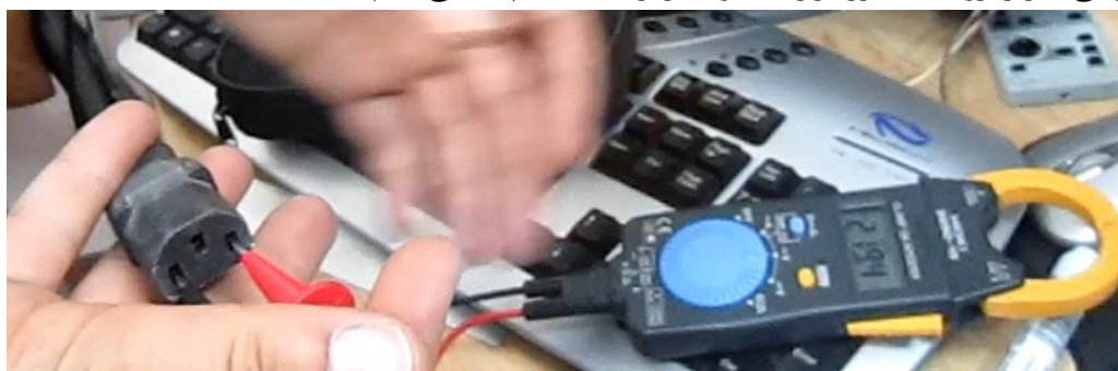
شکل ۲۲- چک کردن کابل پاور با مولتی متر
