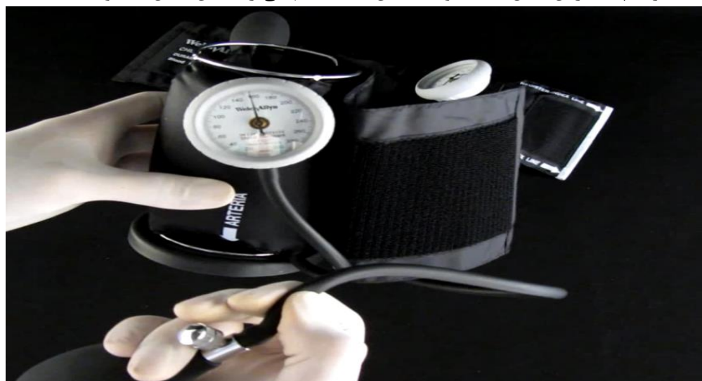
شکل ۷۰- تست فشارسنج: مسدود کردن بخش انتهایی جهت یافتن نشتی
