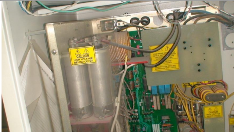
شکل ۱۱۴-شمای بردهای رادیولوژی و خازنهای ولتاژ بالای مربوطه
