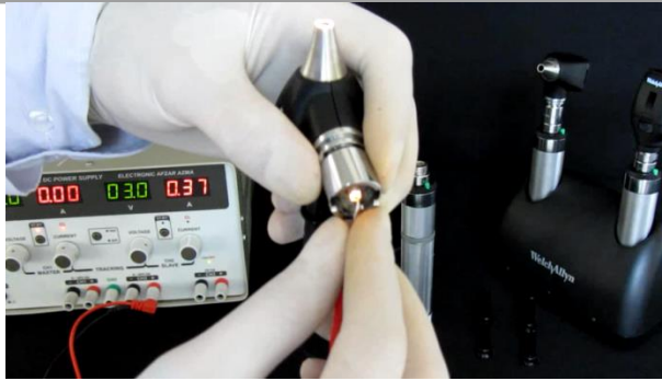
شکل ۴۸- چک کردن اتصالات هد
