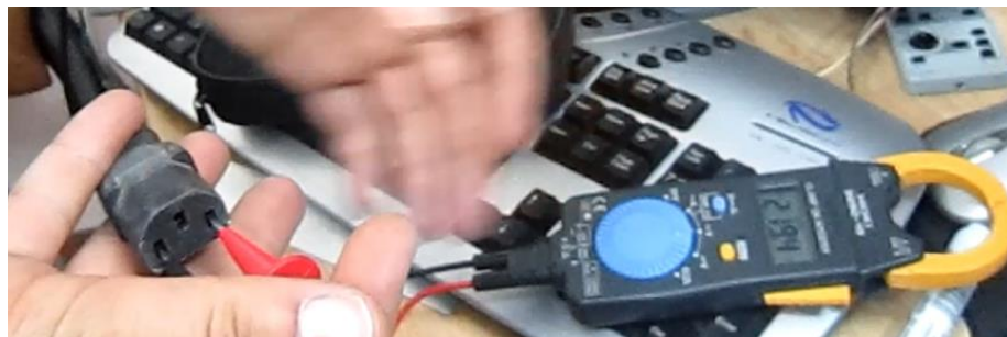
شکل ۷۸- چک کردن کابل پاور پالس اکسی متر با مولتی متر
